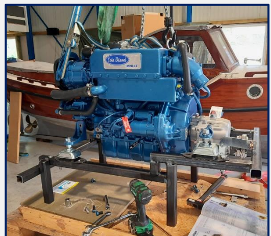
De Sole met motorsteunen op het frame
