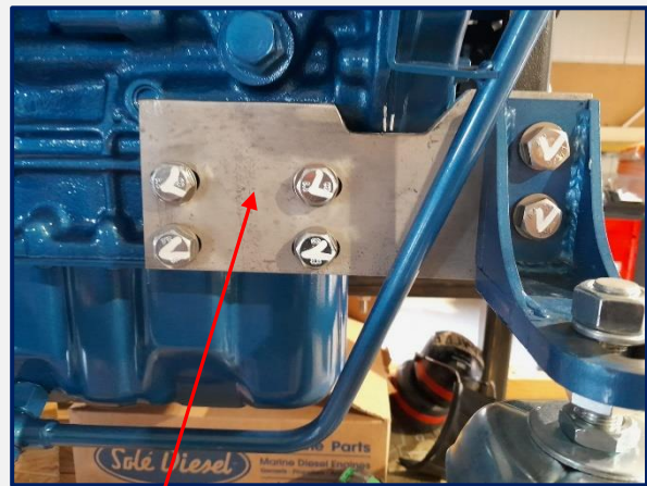
De voorste overbrugging
